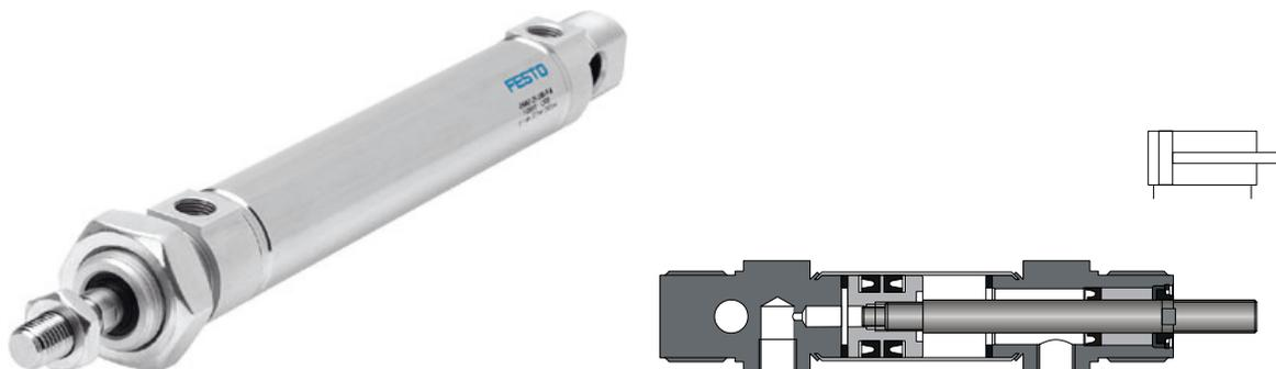
Figura 5.5: Imagen real, dibujo en sección y símbolo de un cilindro de doble efecto
